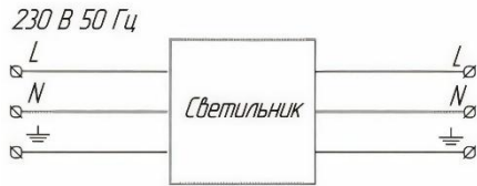
Рис.5. Схема подключения светильника
